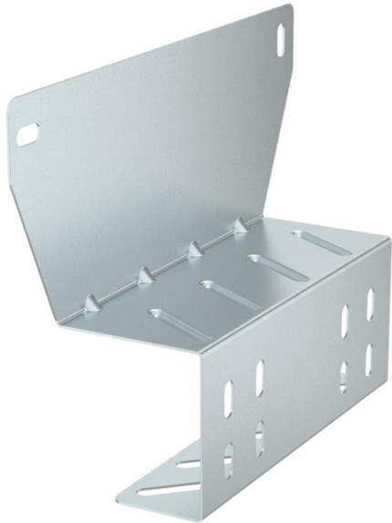
Plaque de montage pour la fixation de boîtes de dérivation de la FireBox série T (avec fixation extérieure) sur des chemins de câbles et des échelles à câbles avec une hauteur latérale de 60 mm. La forme de construction coudée en tôle d'acier renforcée par moulures permet un montage sûr du câble de sécurité de fonctionnement, sans que le câble ne doive être plié sur le longeron.
