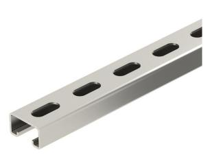
Rail profilé en C lourd pour l'installation individuelle de structures porteuses pour, par exemple, des chemins de câbles, ou comme console pour armoires électriques. Également utilisable pour la pose de câbles, en association avec des brides de fixation rapides avec attache en U.
