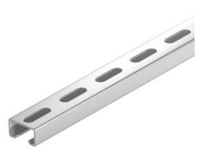
Rail profilé en C lourd pour l'installation individuelle de structures porteuses pour, par exemple, des chemins de câbles, ou comme console pour armoires électriques. Également utilisable pour la pose de câbles, en association avec des brides de fixation rapides avec attache en U.
