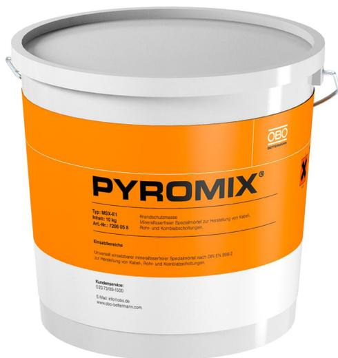
Mortier coupe-feu pour le calfeutrement de pénétration de câble et de pénétration mixte dans les murs maçonnés et dalles béton. Application par pompage, presse ou manuelle. 10 kg de mortier sec donnent environ 10 litres de masse prête à l'emploi en rajoutant env. 3 litres d'eau. Utilisation en intérieur.
