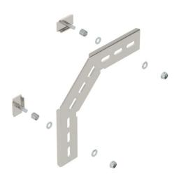
Équerre de montage à 90°, verticale, pour chemin de câbles en treillis en C et chemin de câbles en treillis GR-Magic d'une hauteur latérale de 55 mm. Avec 2 pièces de serrage type KS 23/35 chacun Avec raccord, pour réaliser des coudes à 45°.
