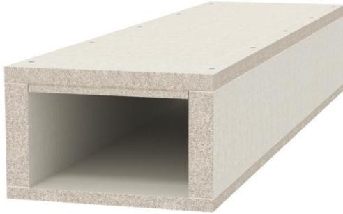
Goulotte coupe-feu composée de béton allégé armé de fibres de verre résistant à l'humidité et au gel de la classe A1 selon EN 13501-1 relative à la pose coupe-feu de câbles dans des voies d'évacuation et issues de secours. Classification EI30 - EI60 en tant que goulotte de montage selon EN 13501-2 à partir d'essais selon EN 1366-5. En cas de charge combustible à l'intérieur (feu de câble), la goulotte empêche la propagation du feu à une autre section par le câble
