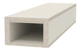
Canale antincendio in calcestruzzo leggero con fibra di vetro resistente all'acqua e al gelo della classe materiali A1 secondo la EN 13501-1 per la posa a prova d'incendio di cavi in vie di fuga e di soccorso. Classificazione El30 - El60 come canale di installazione secondo la EN 13501-2 sulla base di prove secondo la EN 1366-5. In caso di carico di incendio dall'interno (incendio di cavi), il canale ne impedisce la propagazione da una compartimentazione all'altra.
