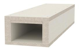
Goulotte coupe-feu composée de béton allégé armé de fibres de verre résistant à l'humidité et au gel de la classe A1 selon EN 13501-1 relative à la pose coupe-feu de câbles dans des voies d'évacuation et issues de secours. Classification El90 comme goulotte d'installation conformément à la norme EN 13501-2 sur la base des essais conformément à la norme EN 1366-5 En cas de charge combustible à l'intérieur (feu de câble), la goulotte empêche la propagation du feu à une autre section par le câble
