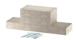
Embase murale pour goulotte coupe-feu PYROLINE® Con D El90, type PLCD D091220, constituée de béton léger en fibre de verre résistant à l'eau et au gel pour le montage sur la goulotte de protection contre les incendies au niveau des raccords muraux et au plafond et/ou des passages dans les parois et les plafonds. Composé de 3 panneaux individuels (largeur 100 mm, épaisseur 40 mm). Fourni avec vis à tête fraisée.
