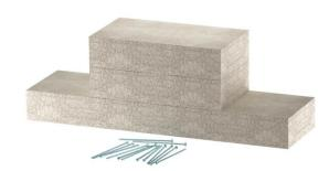
Collare di collegamento a parete per canale antincendio PYROLINE® Con D E190, tipo PLCD D091220 in calcestruzzo leggero con fibra di vetro resistente all'acqua e al gelo per il montaggio sul canale antincendio nell'area dei collegamenti e dei passaggi a parete e a soffitto. Costituito da 3 pannelli singoli (larghezza 100 mm, spessore 40 mm). Incluse viti a testa svasata. Incluse viti a testa svasata.
