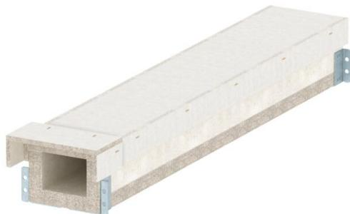
Goulotte coupe-feu composée de béton allégé armé de fibres de verre résistant à l'humidité et au gel de la classe A1 selon EN 13501-1 relative à la pose coupe-feu de câbles dans des voies d'évacuation et issues de secours. Classification EI30 - EI60 en tant que goulotte de montage selon EN 13501-2 à partir d'essais selon EN 1366-5. En cas de charge combustible à l'intérieur (feu de câble), la goulotte empêche la propagation du feu à une autre section par le câble
