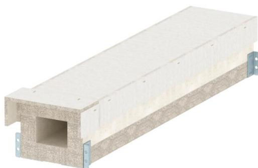
Canale antincendio in calcestruzzo leggero con fibra di vetro resistente all'acqua e al gelo della classe materiali A1 secondo la EN 13501-1 per la posa a prova d'incendio di cavi in vie di fuga e di soccorso. Classificazione EI90 come canale di installazione secondo la EN 13501-2 sulla base di prove secondo la EN 1366-5. In caso di carico di incendio dall'interno (incendio di cavi), il canale ne impedisce la propagazione da una compartimentazione all'altra.
