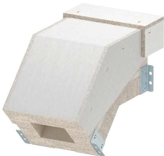
Curva verticale discendente per canale antincendio PYROLINE® Con S EI90, tipo PLCS D090810 in calcestruzzo leggero con fibra di vetro resistente all'acqua e al gelo per realizzare variazioni di direzione verticali (45°) nello sviluppo del canale. I materiali di collegamento montati consentono un rapido montaggio dei pezzi del canale sul posto, i coperchi allentati consentono una rapida revisione e disposizione successiva.
