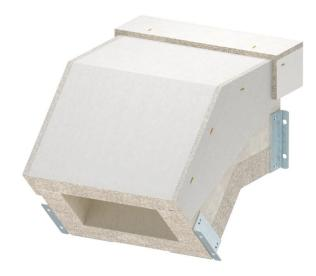
Coude vertical convexe pour goulotte coupe-feu PYROLINE® Con S El90, type PLCS D091220, constitué de béton léger en fibre de verre résistant à l'eau et au gel pour la conception de changements de direction verticaux (45°) dans le sens de la goulotte. Des éclisses d'assemblage prêtes à installer permettent un assemblage rapide des éléments de conduit sur site, et les couvercles simplement posés permettent une inspection et un câblage ultérieur rapides.
