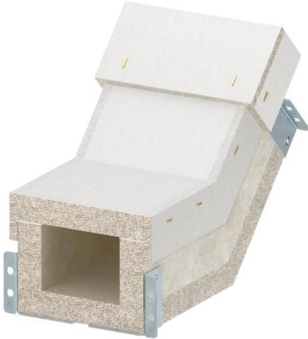
Coude vertical montant pour goulotte coupe-feu PYROLINE® Con S EI60, type PLCS D060810, constitué de béton léger en fibre de verre résistant à l'eau et au gel pour la conception de changements de direction verticaux (45°) dans le sens de la goulotte. Des éclisses d'assemblage prêtes à installer permettent un assemblage rapide des éléments de conduit sur site, et les couvercles simplement posés permettent une inspection et un câblage ultérieurs rapides.
