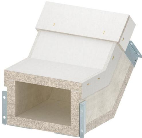
Vertikalbogen steigend für Brandschutzkanal PYROLINE® Con S EI60, Typ PLCS D061220 bestehend aus wasser- und frostbeständigem Glasfaserleichtbeton zur Herstellung von vertikalen Richtungsänderungen (45°) im Kanalverlauf. Fertig montierte Verbindungsbeschläge sorgen für eine schnelle Montage vor Ort, lose aufgelegte Deckel für eine schnelle Revision und Nachbelegung. Inklusive Verbindungsschrauben und Dichtungsstreifen.
