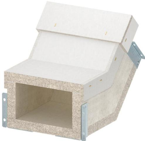
Coude vertical concave pour goulotte coupe-feu PYROLINE® Con S EI60, type PLCS D061220, constitué de béton léger en fibre de verre résistant à l'eau et au gel pour la conception de changements de direction verticaux (45°) dans le sens de la goulotte. Des éclisses d'assemblage prêtes à installer permettent un assemblage rapide des éléments de conduit sur site, et les couvercles simplement posés permettent une inspection et un câblage ultérieurs rapides.
