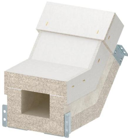
Coude vertical concave pour la goulotte coupe-feu PYROLINE® Con S EI90, type PLCS D090810, en béton léger en fibres de verre résistant à l'eau et au gel pour réaliser des changements de direction verticaux (45°) dans le tracé de la goulotte. Des éclisses d'assemblage prêtes à installer permettent un assemblage rapide des éléments de conduit sur site, et les couvercles simplement posés permettent une inspection et un câblage ultérieur rapides.
