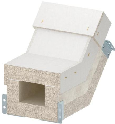
Curva verticale in salita per canale antincendio PYROLINE® Con S EI90, tipo PLCS D090810 in calcestruzzo leggero con fibra di vetro resistente all'acqua e al gelo per realizzare variazioni di direzione verticali (45°) nello sviluppo del canale. I materiali di collegamento montati consentono un rapido montaggio dei pezzi del canale sul posto, i coperchi allentati consentono una rapida revisione e disposizione successiva.
