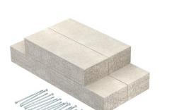
Embase murale pour goulotte coupe-feu PYROLINE® Con S EI60, type PLCS D060810, constituée de béton léger en fibre de verre résistant à l'eau et au gel pour le montage sur la goulotte de protection contre les incendies au niveau des raccords muraux et des passages dans les parois. Composé de 4 panneaux individuels (largeur 50 mm, épaisseur 30 mm).
