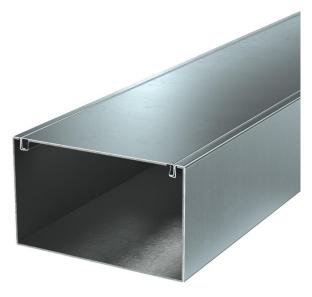
Canale in metallo con tessuto antincendio intumescente per la posa ignifuga dei cavi. Classificato come canale di installazione El30, El60 e El90 a norma EN 13501-2, verificato secondo la norma EN 1366-5. Il canale impedisce la propagazione dell'incendio per l'intervallo di tempo classificato e protegge dalle conseguenze dell'incendio dei cavi.
