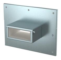
Embases murales à quatre côtés avec joint intégré pour la goulotte de montage PYROLINE® Rapid PLM. Pour le montage en zone de raccordement de mur et de plafond, ainsi que pour les exécutions murales. Également utilisable comme embases murales à trois côtés pour un montage direct au mur ou au plafond de la goulotte.
