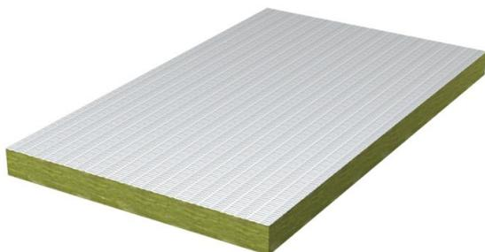
Mit Ablationsbeschichtung PYROCOAT® ASX vorbeschichtete Mineralfaserplatte als Basis für das Weichschottsystem PYROPLATE® Fibre. 60-mm-Platte für Abschottung gemäß europäischer Zulassung. Anwendung im Innenbereich.
