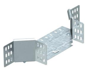
Derivazione laterale per l'impiego orizzontale e verticale. Per tutti i tipi di passerelle portacavi con altezza del bordo pari a 85 mm. L'articolo viene fornito non montato. Incluso materiale di fissaggio.
