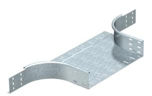
Derivazione laterale per l'impiego orizzontale e verticale. Per tutti i tipi di passerelle portacavi con altezza del bordo pari a 85 mm.
