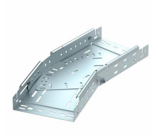
Curva regolabile 0 -  $90^\circ$  con sistema di attacco rapido. Per tutti i tipi di passerelle portacavi con altezza del bordo pari a 60~mm.
