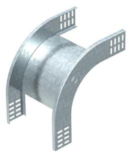
Coude vertical à 90° convexe pour tous les types de chemins de câbles d'une hauteur latérale de 60 mm. Le coude vertical est emboîté et vissé sur l'extrémité du chemin de câbles.
