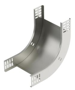
Coude vertical à  $90^{\circ}$  concave pour tous les types de chemins de câbles d'une hauteur latérale de 60 mm. Le coude vertical est emboîté et vissé sur l'extrémité du chemin de câbles.
