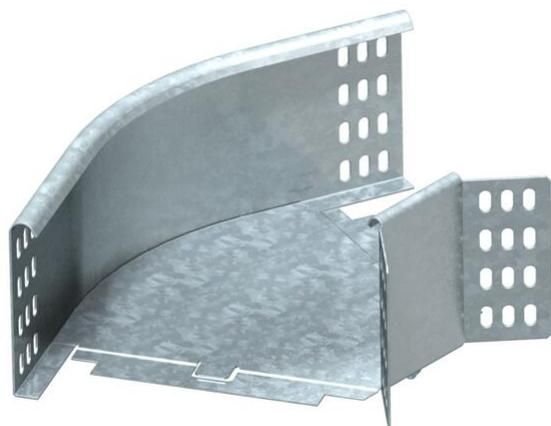
Bogen 45°, horizontal, für alle Kabelrinentypen mit der Seitenhöhe 110 mm. Das Formteil wird in unmontiertem Zustand geliefert. Der Winkelverbinder WKV 110 ist für 90°-Bögen vorgesehen und wird vor Ort auf 45° angepasst. Inklusive anteiligem Befestigungsmaterial.
