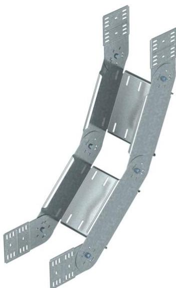
Gelenkbogen 90°, vertikal, für alle Kabelrinentypen mit der Seitenhöhe 110 mm. Der Bogen wird im unmontierten Zustand geliefert. Es sind keine weiteren Befestigungsmaterialien notwendig.
