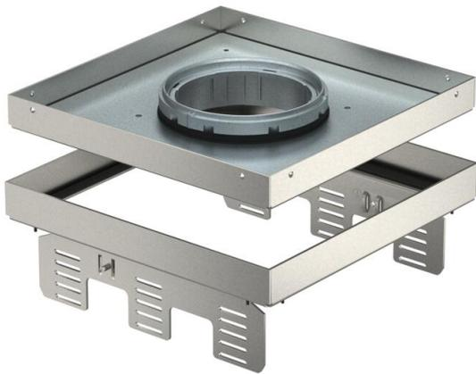
Cassette réglable en hauteur et décollée par rapport au plancher de taille nominale 9, pour Tubus, pour le montage d'appareillages dans des planchers nettoyés à sec ou à l'eau en intérieur, pour le montage dans des boîtes de tirage UZD250-3 ou UZD350-3, en association avec un couvercle de montage DUG../9 ou dans des boîtes de tirage UGD250-3/9 ou UGD350-3/9. Le montage s'effectue à l'aide d'équerres de nivellement (à commander séparément) dans le profilé de cadre en aluminium des boîtes de sol.
