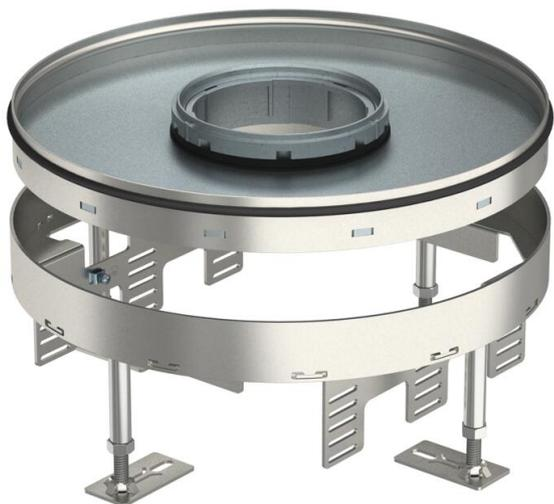
Cassetta tonda per carichi pesanti per Tubus di dimensione nominale R9 per l'installazione di accessori in sistemi di canalizzazione, pavimenti sopraelevati e intercapedini, in pavimenti puliti a secco o a umido in ambienti interni. Classe di carico 2 fino a 20 kN.
