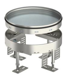
Cassette ronde pleine pour charges lourdes de taille nominale R4 pour la réalisation d'une trappe d'inspection dans les systèmes de goulottes, les faux-planchers et les planchers creux, dans des planchers nettoyés à l'eau ou à sec en intérieur. Classe de charge 2 jusqu'à 20 kN. Convient uniquement aux revêtements de sol lisses.
