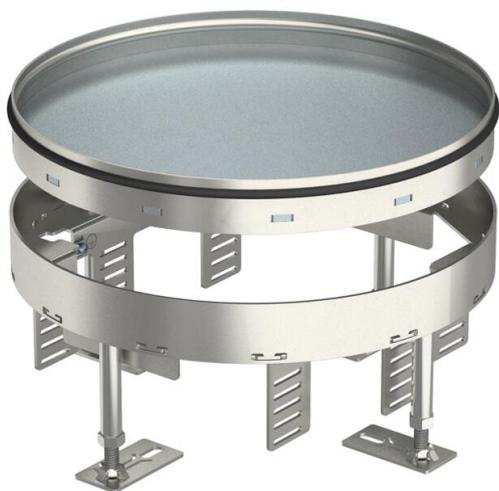
Cassetta tonda per carichi pesanti, "cieca", di dimensioni nominali R7, per la realizzazione di un'apertura di ispezione in sistemi di condotti, in pavimenti doppi e con intercapedini e in pavimenti trattati a secco, umido o bagnato in ambienti interni. Classe di carico 2 fino a 20 kN. Adatto solo per pavimenti lisci.
