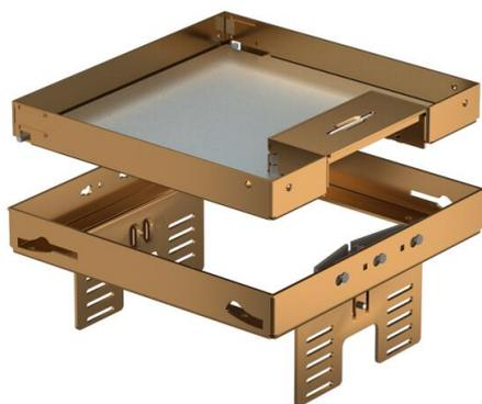
Cassetta livellabile e separabile dal pavimento della dimensione nominale 4, con uscita cavo, per il montaggio di apparecchi d'installazione in pavimenti trattati a secco in ambienti interni, da montare nelle scatole sotto pavimento UZD250-3 o UZD350-3, ognuna in connessione con un coperchio di montaggio DUG..1/4 o in UGD250-3/4 o UGD350-3/4. Il montaggio avviene per mezzo dell'angolare di livellamento (da ordinare separatamente) nel profilo del telaio in alluminio della scatola sotto pavimento.
