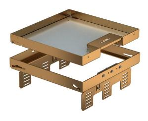
Cassetta livellabile e separabile dal pavimento della dimensione nominale 9, con uscita cavo, per il montaggio di apparecchi d'installazione in pavimenti trattati a secco in ambienti interni, da montare nelle scatole sotto pavimento UZD250-3 o UZD350-3, ognuna in connessione con un coperchio di montaggio DUG../9 o in UGD250-3/9 o UGD350-3/9. Il montaggio avviene per mezzo dell'angolare di livellamento (da ordinare separatamente) nel profilo del telaio in alluminio della scatola sotto pavimento.
