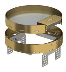
Cassetta livellabile e separabile dal pavimento della dimensione nominale R4, con uscita cavo, per il montaggio di apparecchi d'installazione in pavimenti trattati a secco in ambienti interni, da montare nelle scatole sotto pavimento UZD250-3 o UZD350-3, ognuna in connessione con un coperchio di montaggio DUG..R4 o in UGD250-3R4 o UGD350-3R4. Il montaggio viene eseguito nei profili del telaio in alluminio della scatola sotto pavimento tramite angolari di livellamento (da ordinare separatamente).
