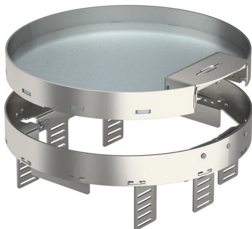
Cassetta livellabile e separabile dal pavimento della dimensione nominale R7, con uscita cavo, per il montaggio di apparecchi d'installazione in pavimenti trattati a secco in ambienti interni, da montare nelle scatole sotto pavimento UZD350-3, ognuna in connessione con un coperchio di montaggio DUG350-3R7 o in UGD350-3R7. Il montaggio viene eseguito nei profili del telaio in alluminio della scatola sotto pavimento tramite angolari di livellamento (da ordinare separatamente).
