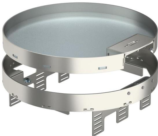
Cassette réglable en hauteur et décollée par rapport au plancher de taille nominale R9, avec sortie de cordon, pour le montage d'appareillages dans des planchers nettoyés à sec en intérieur, pour le montage dans des boîtes de tirage UZD350-3 en association avec un couvercle de montage DUG350-3R9 ou dans des boîtes de tirage UGD350-3R9. Le montage s'effectue à l'aide d'équerres de nivellement (à commander séparément) dans le profilé de cadre en aluminium des boîtes de sol.
