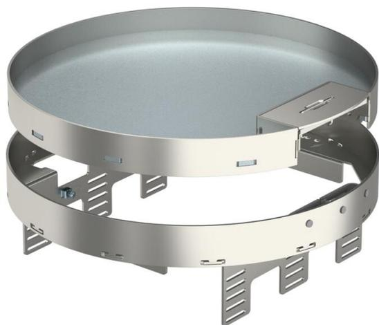
Cassetta livellabile e separabile dal pavimento della dimensione nominale R9, con uscita cavo, per il montaggio di apparecchi d'installazione in pavimenti trattati a secco in ambienti interni, da montare nelle scatole sotto pavimento UZD350-3, ognuna in connessione con un coperchio di montaggio DUG350-3R9 o in UGD350-3R9. Il montaggio viene eseguito nei profili del telaio in alluminio della scatola sotto pavimento tramite angolari di livellamento (da ordinare separatamente).
