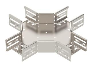
Croix pour créer une dérivation horizontale, pièce de forme pour chemins de câbles encliquetables et vissables d'une hauteur d'aile de 60 mm. Montage sans vis avec bornes doubles ou raccord vissé avec vis à tête bombée FRS et écrou à rondelle sertie M6. Utilisable en intérieur et en extérieur. Le matériel de fixation doit être commandé séparément.
