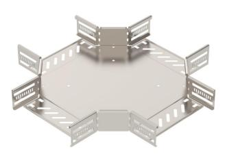
Croix pour créer une dérivation horizontale, pièce de forme pour chemins de câbles encliquetables et vissables d'une hauteur d'aile de 60 mm. Montage sans vis avec bornes doubles ou raccord vissé avec vis à tête bombée FRS et écrous à rondelle sertie M6. Utilisable en intérieur et en extérieur. Le matériel de fixation doit être commandé séparément.
