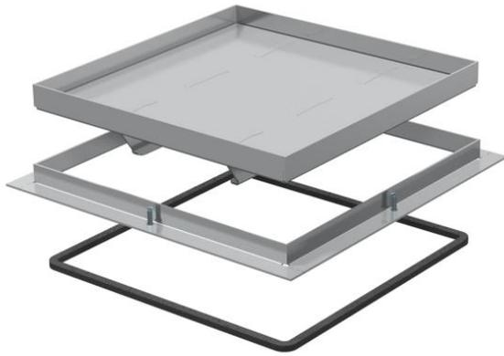
Cassette à cadre pleine pour charges lourdes pour la réalisation d'une trappe d'inspection dans les boîtes de tirage UZD250-3 dans des planchers nettoyés à l'eau ou à sec en intérieur. Classe de charge 1 jusqu'à 10 kN. Convient uniquement aux revêtements de sol lisses.
