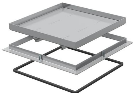
Cassetta con telaio per carichi pesanti, "cieca", per la realizzazione di un'apertura di ispezione nella UZD350-3 in pavimenti trattati a secco o umido in ambienti interni. Classe di carico 1 fino a 10 kN. Adatta solo per pavimenti lisci in ambienti interni.
