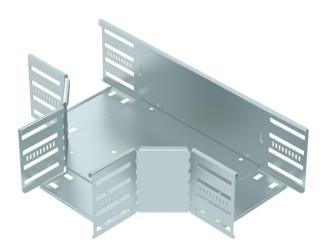
Pièce en T pour créer une dérivation horizontale, pièce de forme pour chemins de câbles encliquetables et vissables d'une hauteur d'aile de 110 mm. Montage sans vis avec bornes doubles ou raccord vissé avec vis à tête bombée FRS et écrous à rondelle sertie M6. Utilisable en intérieur. Le matériel de fixation doit être commandé séparément.
