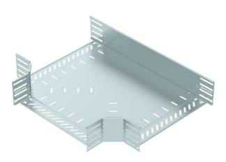
T-Stück zum Erstellen einer horizontalen Abzweigung, Formteil für rast- und schraubbare Kabelrinnen Seitenhöhe 110 mm. Schraubenlose Montage mit Doppelklemmen oder Schraubverbindung mit Flachrundschrauben FRS und Kombimuttern M6. Einsetzbar im Innenbereich. Befestigungsmaterial muss separat bestellt werden.
