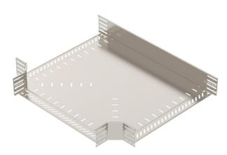
Pièce en T pour créer une dérivation horizontale, pièce de forme pour chemins de câbles encliquetables et vissables d'une hauteur d'aile de 110 mm. Montage sans vis avec bornes doubles ou raccord vissé avec vis à tête bombée FRS et écrous à rondelle sertie M6. Utilisable en intérieur et en extérieur. Le matériel de fixation doit être commandé séparément.
