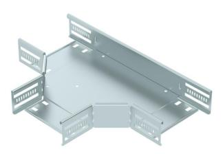
T-Stück zum Erstellen einer horizontalen Abzweigung, Formteil für rast- und schraubbare Kabelrinnen Seitenhöhe 60 mm. Schraubenlose Montage mit Doppelklemmen oder Schraubverbindung mit Flachrundschrauben FRS und Kombimuttern M6. Einsetzbar im Innenbereich. Befestigungsmaterial muss separat bestellt werden.
