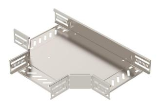
T-Stück zum Erstellen einer horizontalen Abzweigung, Formteil für rast- und schraubbare Kabelrinnen Seitenhöhe 60 mm. Schraubenlose Montage mit Doppelklemmen oder Schraubverbindung mit Flachrundschrauben FRS und Kombimuttern M6. Einsetzbar im Innen- und Außenbereich. Befestigungsmaterial muss separat bestellt werden.
