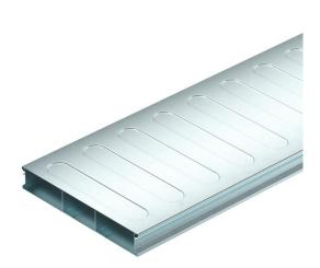
Goulotte sous plancher (en 2 parties) pour la pose de câbles et lignes dans des systèmes sous plancher noyés dans la chape selon EN 50085-2-2. Couvercle de goulotte amovible, emboîtable sur toute la longueur. Avec séparateur dans la partie inférieure de la goulotte.
